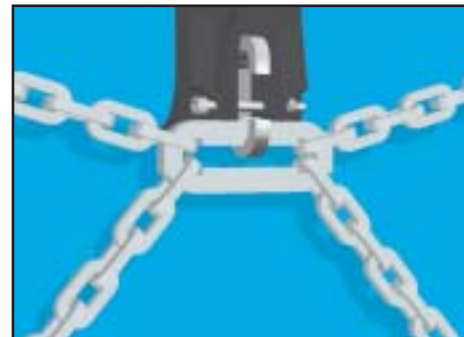
Élément de réglage en position « long » (dans le sens de la marche)
