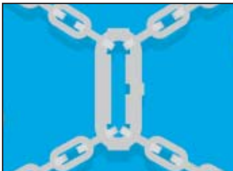
Élément de réglage en position « court » (perpendiculaire au sens de la marche)
